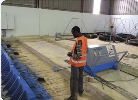
Para tensar cables o hilos
