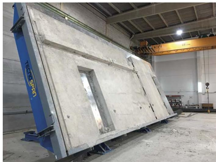
**Las mesas basculantes se utilizan para la producción de piezas prefabricadas de gran superficie con armadura no pretensada y están disponibles en diferentes medidas. Para facilitar el vaciado y recepción de los paneles, pueden inclinarse hasta 75°.**
