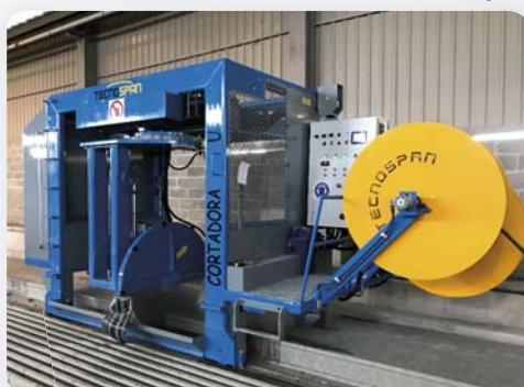
**Para el corte de elementos fabricados**
