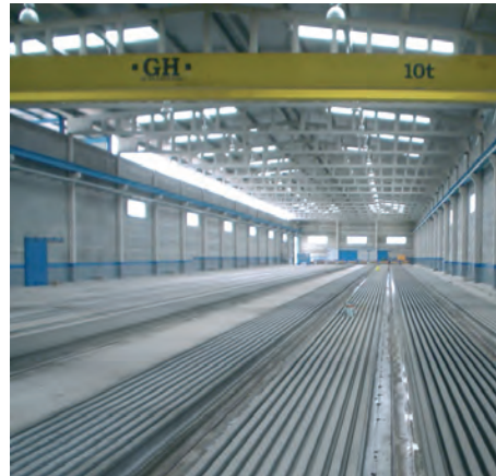
Produkcja belek dwuteowych
