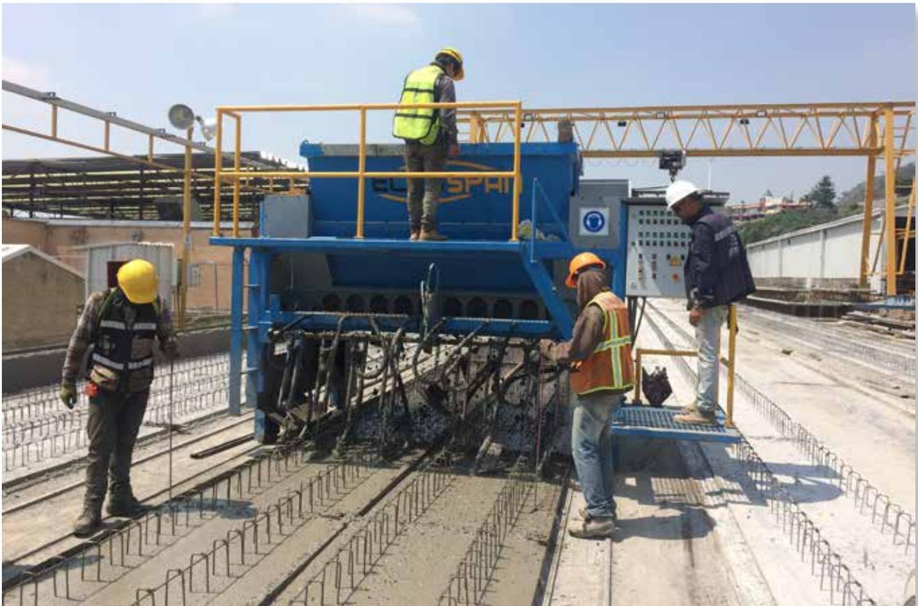
Fabricación de prelasas pretensadas con armadura vista en 1.200 y 2.400 (Guadalajara, México)
