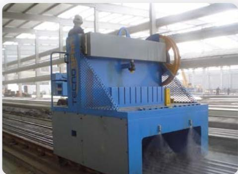
Para el extendido y reparto de cables o hilos
