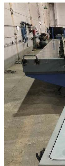
**Los moldes para pilares con o sin ménsulas, columnas, jácenas y otros elementos similares para la construcción industrial y comercial se pueden suministrar en línea simple o doble, con sistema de calefacción y diferentes grados de automatización.**
