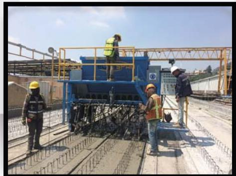
**Para la distribución y vibración del hormigón en pistas**
