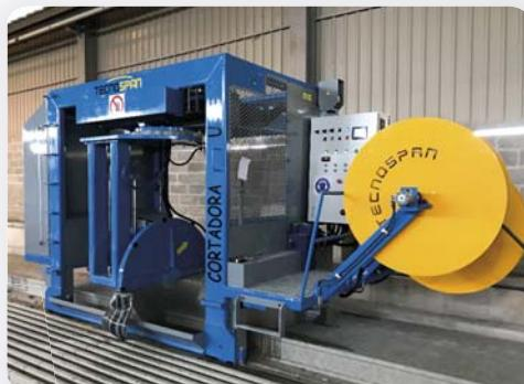
**Para el corte de elementos fabricados**
