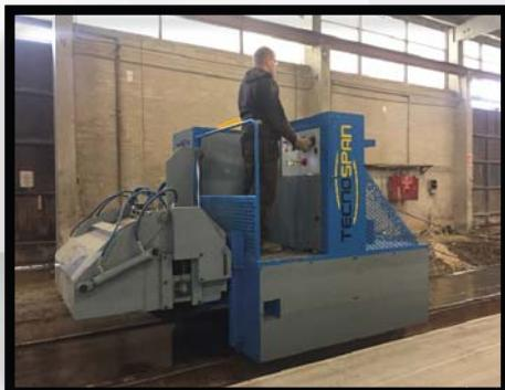
**Para limpiar, lanzar cables y poner desencofrante en pistas**
